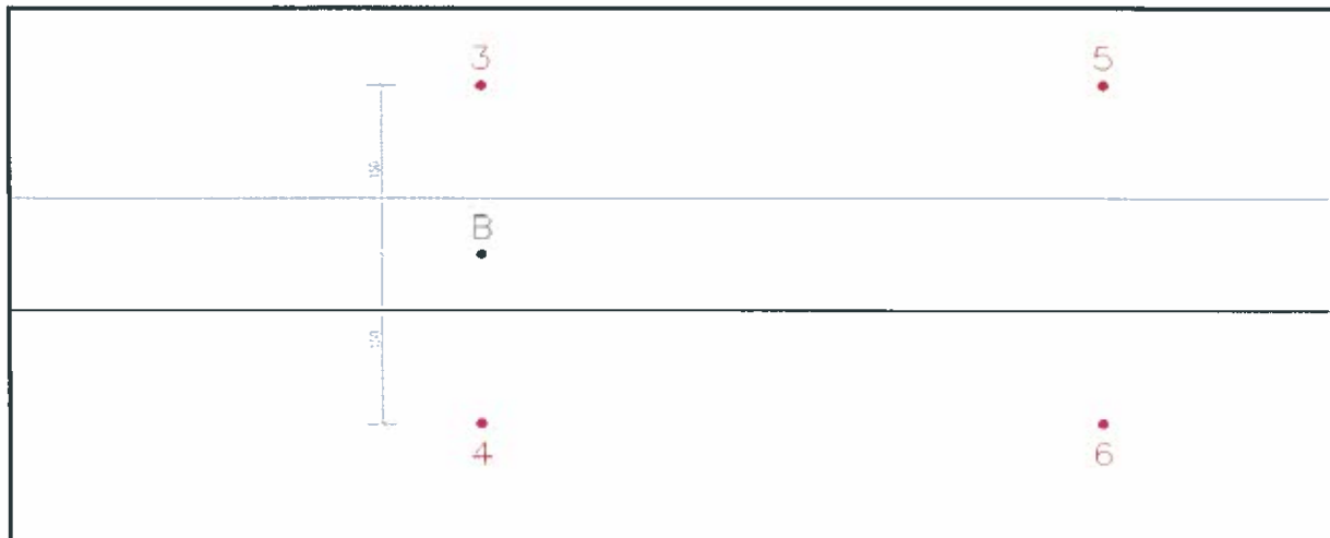
Figura 8b: Pozzi presi in considerazione per l'abbassamento di falda nel punto B
