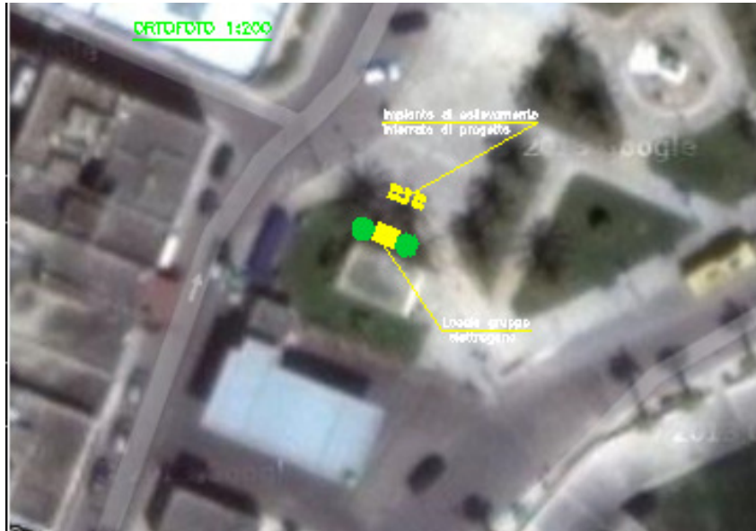
Ubicazione planimetrica/ortofoto dell'impianto di sollevamento fognario
