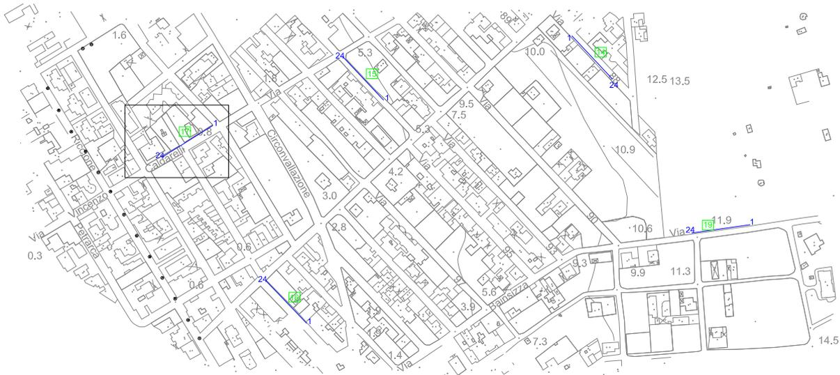
Il sondaggio è stato eseguito sul bordo di via Caldarelli. La lunghezza del profilo è di 60 m e la distanza intergeofonica di 2,5 m. Lo scoppio 1 è stato realizzato nel punto di coordinate UTM 4460665.22 m N, 746876.38 m E e quota 0,9 m slm mentre lo scoppio 5 è stato realizzato nel punto di coordinate UTM 4460632.68 m N, 746821.42 m E e quota 0,7 m slm.
