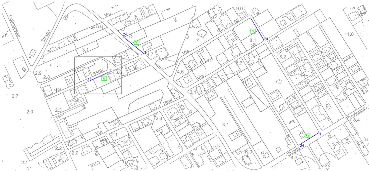
Il sondaggio è stato eseguito su via Enzo Ferrari, lungo la banchina stradale. La lunghezza del profilo è di 48 m e la distanza intergeofonica di 2,0 m. Lo scoppio 1 è stato realizzato nel punto di coordinate UTM 4461277.30 m N, 746399.54 m E e quota 3,6 m slm mentre lo scoppio 5 è stato realizzato nel punto di coordinate UTM 4461255.67 m N, 746354.66 m E e quota 3,5 m slm
