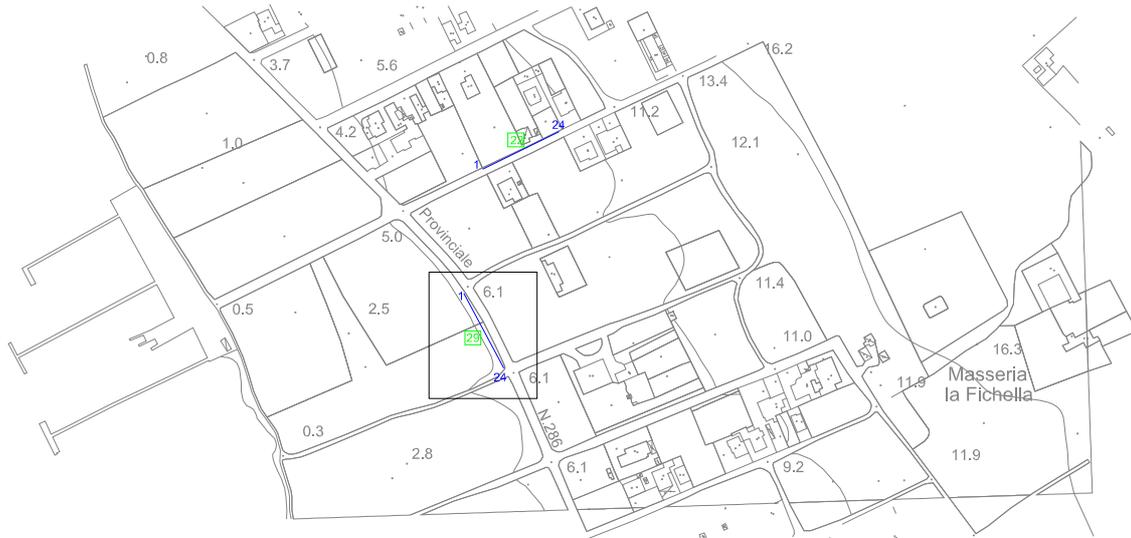
Il sondaggio è stato eseguito sulla strada litoranea (SP n. 286), a margine della banchina stradale. La lunghezza del profilo è di 60 m e la distanza intergeofonica di 2,5 m. Lo scoppio 1 è stato realizzato nel punto di coordinate UTM 4459774.61 m N, 747420.76 m E e quota 6,1 m slm mentre lo scoppio 5 è stato realizzato nel punto di coordinate UTM 4459734.84 m N, 747460.05 m E e quota 6,1 m slm.
