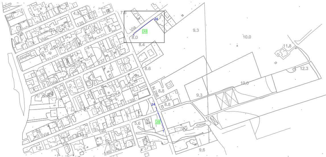
Il sondaggio è stato eseguito su una traversa senza denominazione della strada litoranea per S. Isidoro (SP n. 286), sulla banchina stradale. La lunghezza del profilo è di 60 m e la distanza intergeofonica di 2,5 m. Lo scoppio 1 è stato realizzato nel punto di coordinate UTM 4459043.40 m N, 747852.70 m E e quota 8,1 m slm mentre lo scoppio 5 è stato realizzato nel punto di coordinate UTM 4459081.63 m N, 747903.91 m E e quota 8,4 m slm.
