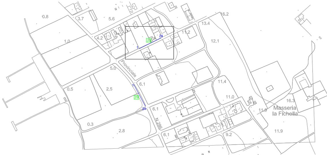
Il sondaggio è stato eseguito sul bordo di via De Pascalis. La lunghezza del profilo è di 60 m e la distanza intergeofonica di 2,5 m. Lo scoppio 1 è stato realizzato nel punto di coordinate UTM 4459706.61 m N, 747587.67 m E e quota 7,7 m slm mentre lo scoppio 5 è stato realizzato nel punto di coordinate UTM 4459735.02 m N, 747644.69 m E e quota 8,1 m slm.
