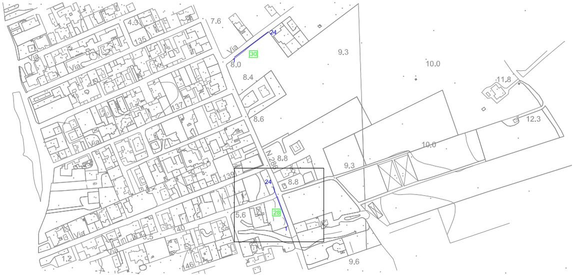
Il sondaggio è stato eseguito sulla strada litoranea (SP n. 286), in località La Strea, sulla banchina stradale. La lunghezza del profilo è di 60 m e la distanza intergeofonica di 2,5 m. Lo scoppio 1 è stato realizzato nel punto di coordinate UTM 4458802.80 m N, 747928.40 m E e quota 8,8 m slm mentre lo scoppio 5 è stato realizzato nel punto di coordinate UTM 4458848.91 m N, 747913.76 m E e quota 8,9 m slm.
