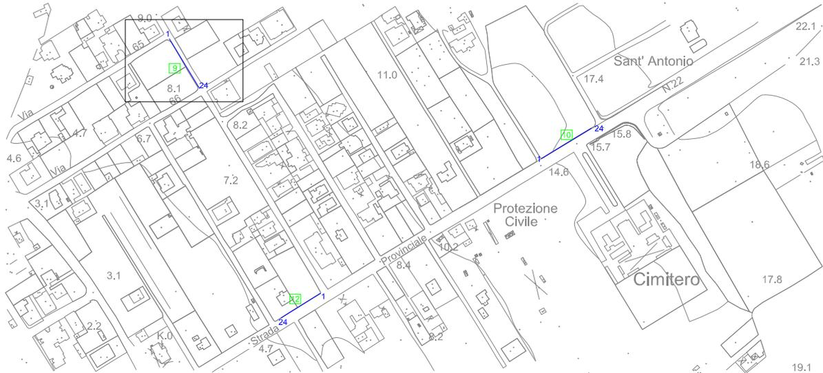
Il sondaggio è stato eseguito su via senza nome tra gli incroci con via Biagi e via Bachelet, lungo la banchina stradale. La lunghezza del profilo è di 48 m e la distanza intergeofonica di 2,0 m. Lo scoppio 1 è stato realizzato nel punto di coordinate UTM 4461398.22 m N, 746717.29 m E e quota 8,9 m slm mentre lo scoppio 5 è stato realizzato nel punto di coordinate UTM 4461348.86 m N, 746746.70 m E e quota 8,8 m slm.
