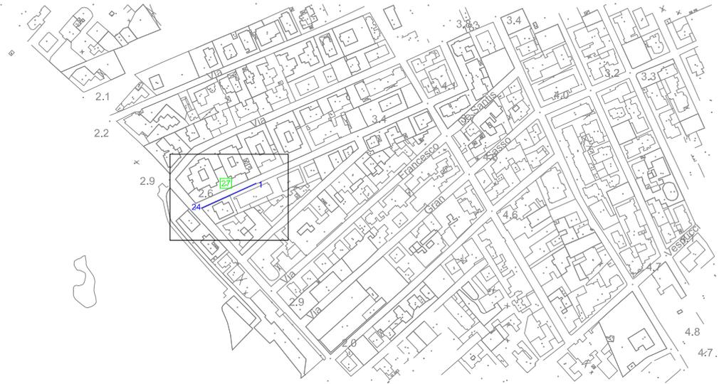
Il sondaggio è stato eseguito sul bordo di via G. Angeli, in corrispondenza dell'incrocio con via V. Monti. La lunghezza del profilo è di 60 m e la distanza intergeofonica di 2,5 m. Lo scoppio 1 è stato realizzato nel punto di coordinate UTM 4461129.27 m N, 745576.29 m E e quota 2,7 m slm mentre lo scoppio 5 è stato realizzato nel punto di coordinate UTM 4461102.94 m N, 745519.10 m E e quota 2,6 m slm.
