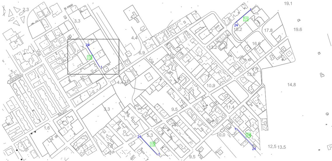
Il sondaggio è stato eseguito sul bordo di via Don Cosimo Mele. La lunghezza del profilo è di 48 m e la distanza intergeofonica di 2,0 m. Lo scoppio 1 è stato realizzato nel punto di coordinate UTM 4460907.83 m N, 746908.59 m E e quota 3,9 m slm mentre lo scoppio 5 è stato realizzato nel punto di coordinate UTM 4460956.48 m N, 746877.41 m E e quota 3,8 m slm.
