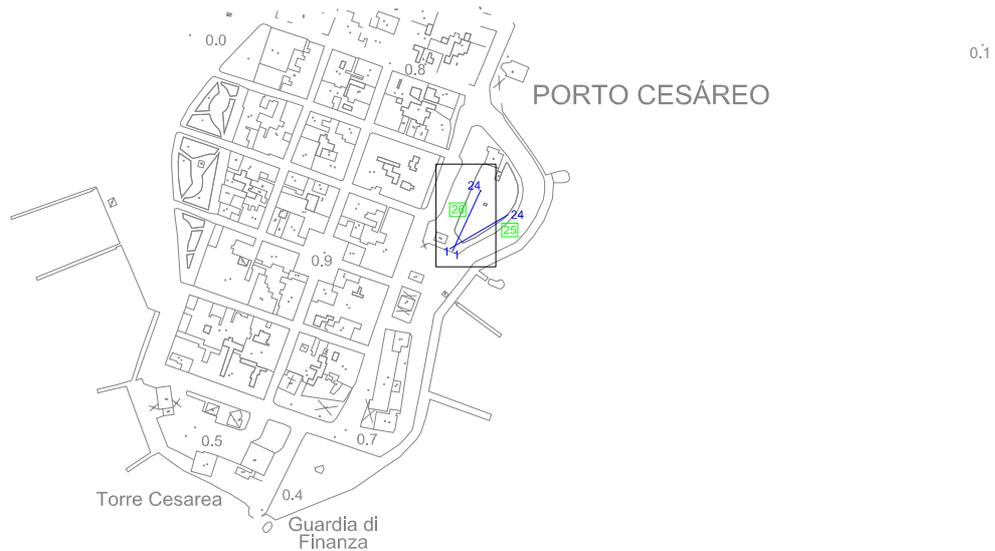
Il sondaggio è stato eseguito sul bordo della piazzetta su cui insiste il monumento ai caduti, nei pressi del distributore di carburanti Totalerg. La lunghezza del profilo è di 48 m e la distanza intergeofonica di 2,0 m. Lo scoppio 1 è stato realizzato nel punto di coordinate UTM 4460437.92 m N, 746078.86 m E e quota 0,4 m slm mentre lo scoppio 5 è stato realizzato nel punto di coordinate UTM 4460482.84 m N, 746095.20 m E e quota 0,4 m slm.
