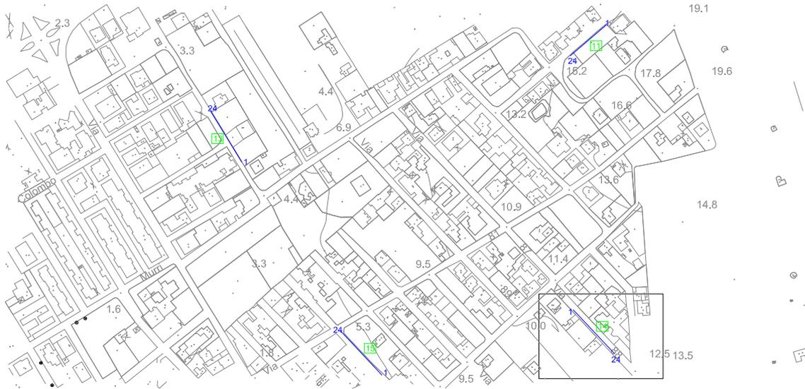
Il sondaggio è stato eseguito sul bordo di via Don Lorenzo Milani. La lunghezza del profilo è di 60 m e la distanza intergeofonica di 2,5 m. Lo scoppio 1 è stato realizzato nel punto di coordinate UTM 4460756.71 m N, 747239.55 m E e quota 12,2 m slm mentre lo scoppio 5 è stato realizzato nel punto di coordinate UTM 4460706.85 m N, 747284.94 m E e quota 12,4 m slm.
