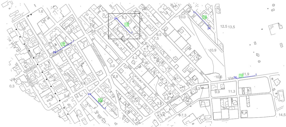
Il sondaggio è stato eseguito sul bordo di via Don Cosimo Mele. La lunghezza del profilo è di 60 m e la distanza intergeofonica di 2,5 m. Lo scoppio 1 è stato realizzato nel punto di coordinate UTM 4460907.83 m N, 746908.59 m E e quota 5,1 m slm mentre lo scoppio 5 è stato realizzato nel punto di coordinate UTM 4460956.48 m N, 746877.41 m E e quota 5,2 m slm.
