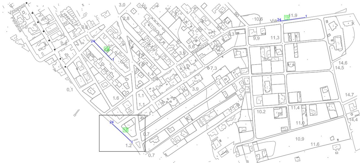
Il sondaggio è stato eseguito sul marciapiede di via Riccione in corrispondenza dell'incrocio con la circonvallazione. La lunghezza del profilo è di 60 m e la distanza intergeofonica di 2,5 m. Lo scoppio 1 è stato realizzato nel punto di coordinate UTM 4460265.96 m N, 747022.38 m E e quota 1,2 m slm mentre lo scoppio 5 è stato realizzato nel punto di coordinate UTM 4460318.00 m N, 746972.70 m E e quota 1,1 m slm.
