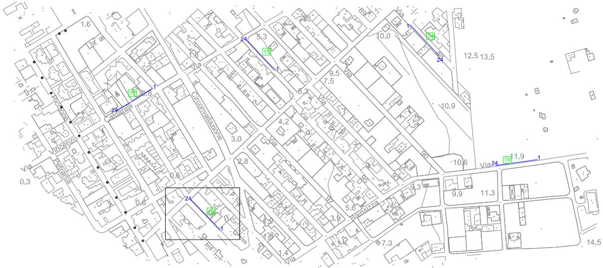
Il sondaggio è stato eseguito sul bordo di via Tecchi. La lunghezza del profilo è di 60 m e la distanza intergeofonica di 2,5 m. Lo scoppio 1 è stato realizzato nel punto di coordinate UTM 4460466.01 m N, 746970.23 m E e quota 1,1 m slm mentre lo scoppio 5 è stato realizzato nel punto di coordinate UTM 4460508.84 m N, 746929.32 m E e quota 1,3 m slm.
