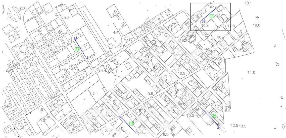
Il sondaggio è stato eseguito sul bordo strada di una via da denominarsi posta alle spalle del Cimitero. La lunghezza del profilo è di 48 m e la distanza intergeofonica di 2,0 m. Lo scoppio 1 è stato realizzato nel punto di coordinate UTM 4461044.92 m N, 747271.89 m E e quota 16,0 m slm mentre lo scoppio 5 è stato realizzato nel punto di coordinate UTM 4461012.68 m N, 747234.68 m E e quota 15,8 m slm.
