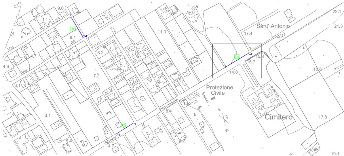
Il sondaggio è stato eseguito su via Giuseppe Garibaldi (Provinciale n. 22), sul marciapiede dirimpetto al Cimitero. La lunghezza del profilo è di 60 m e la distanza intergeofonica di 2,5 m. Lo scoppio 1 è stato realizzato nel punto di coordinate UTM 4461276.16 m N, 747098.67 m E e quota 14,6 m slm mentre lo scoppio 5 è stato realizzato nel punto di coordinate UTM 4461309.29 m N, 747153.46 m E e quota 14,3 m slm.
