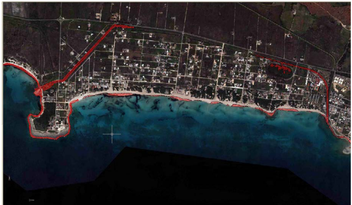
Figura 7.2.2 – Zone inondabili con marea e sollevamento medio mare di 0.30m (Tr =50 anni).
