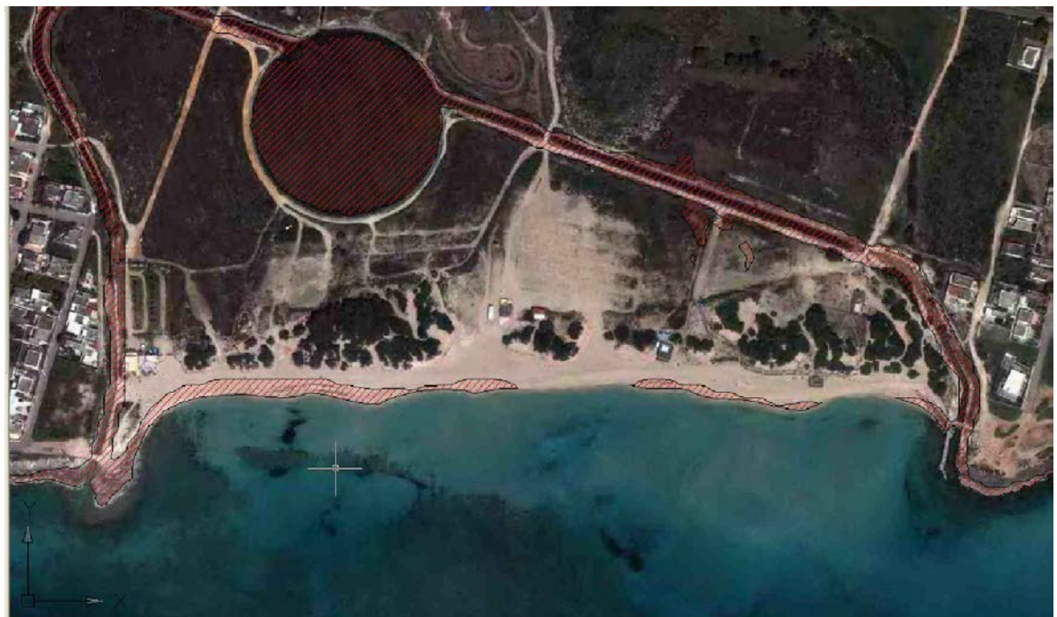
Figura 7.5.2 – Zone inondabili con marea e sollevamento medio mare di 0.30m (Tr =50 anni).
