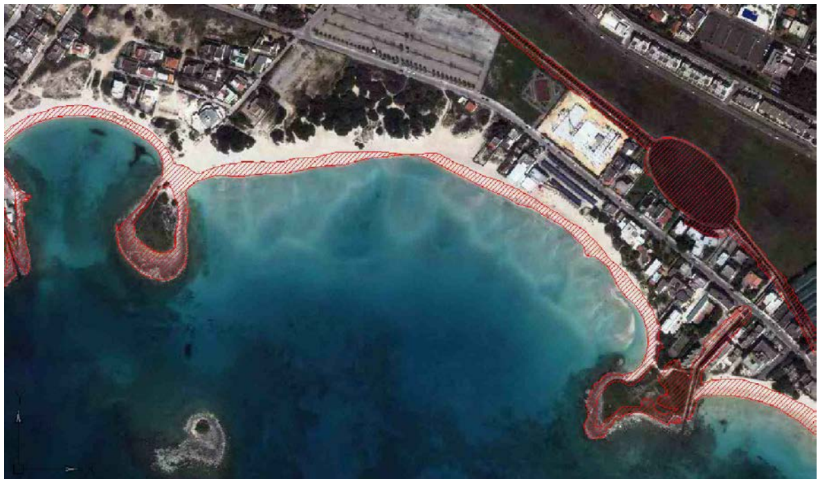
Figura 7.10.4 – Zone inondabili con sollevamento medio mare di 0.30m, marea meteorologica e wave setup ( T_r = 50 anni).
